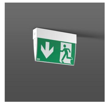
Universelle Kunststoffleuchte zur Rettungswegkennzeichnung. Gehäuse Kunststoff (Polycarbonat), schlagzäh. 4 Rettungszeichenfolien und 1 weiße Folie zum Einlegen in die transparente Abdeckung beigelegt. Befestigungswinkel zur Wandmontage und zwei Dichtschrauben beigepackt. Einzelbatteriesystem mit automatischem Selbsttest.
