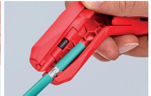
Abmanteln eines Koax-Kabels
