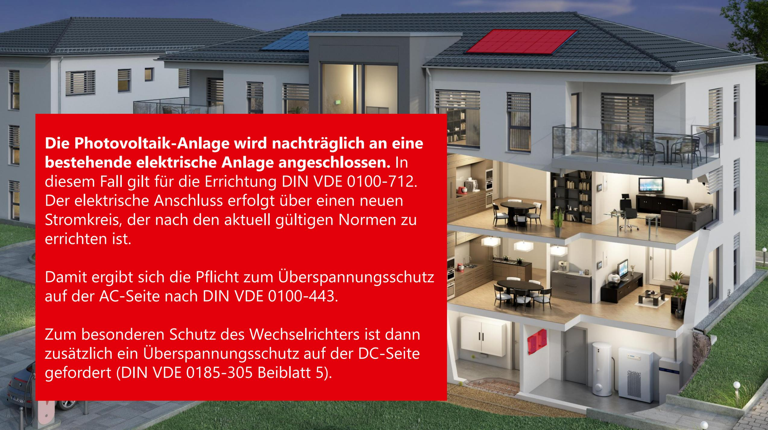
**Die Photovoltaik-Anlage wird nachträglich an eine bestehende elektrische Anlage angeschlossen. In diesem Fall gilt für die Errichtung DIN VDE 0100-712. Der elektrische Anschluss erfolgt über einen neuen Stromkreis, der nach den aktuell gültigen Normen zu errichten ist.**
