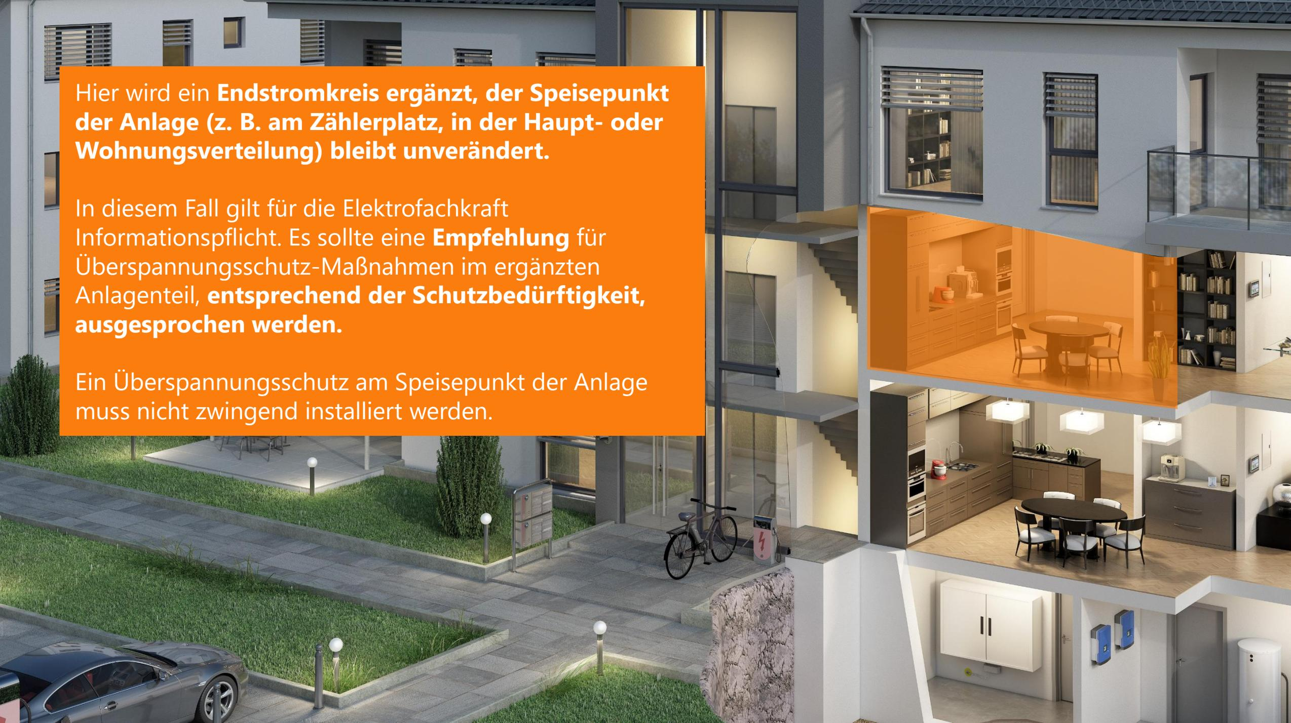
**Der Zählerplatz (Hauptverteilung) bleibt unverändert, es erfolgt eine Erneuerung oder Erweiterung der Elektroinstallation in der Wohnung. In diesem Fall muss ein Überspannungsschutz im Wohnungsverteiler installiert werden.**
