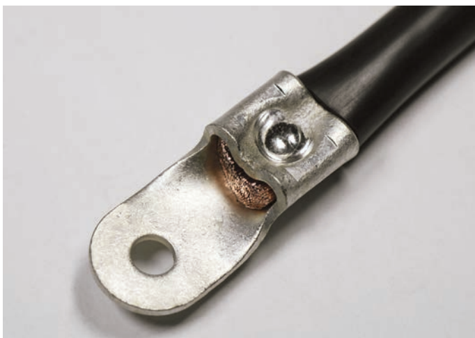
Bild 14: Quetschkabelschuh mit Dornpresseinsatz Q22 verpresst
