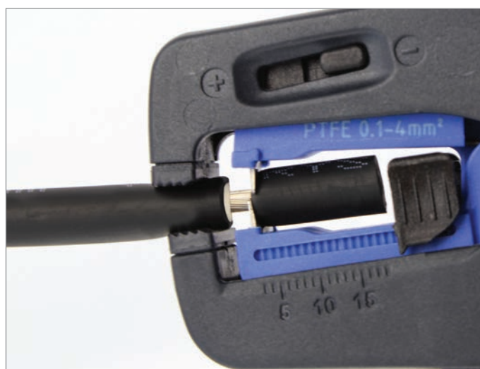
Bild 9: Isolationen werden rundherum eingeschnitten und verringern so die Abzugskräfte.
