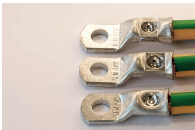
Bild 24: F-Kabelschuh mit Dornverpressung, Vorderseite. Überpressung, richtige Verpressung, Unterpressung (v.o.)
