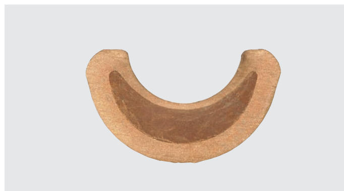
Bild 12: Schliffbild Dornpressung Klasse 6 Leiter im F-Kabelschuh
