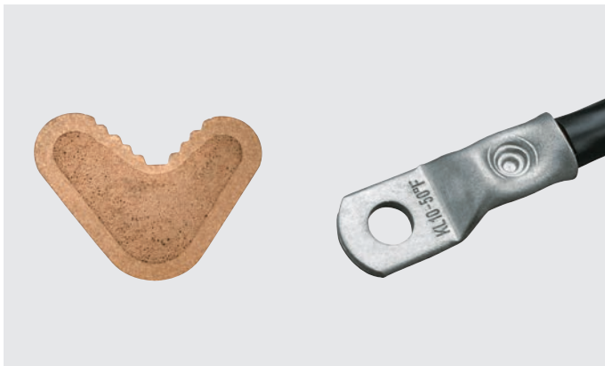
Bild 7: Schliffbild Kupfer Klasse 5 und verpresster Kabelschuh R-Serie (Dornpressung)
