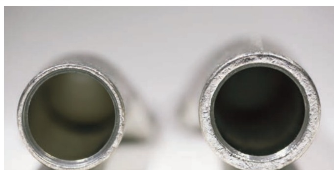
Bild 11: Wandstärke eines Rohrkabelschuhs und eines DIN Kabelschuhs im Vergleich (Innenansicht)
