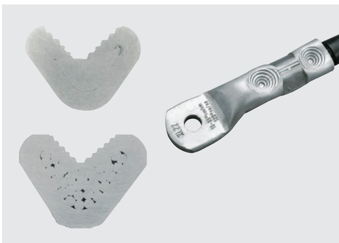
Bild 8: Schliffbild Aluminium Klasse 1, 2 und verpresster Kabelschuh Al-Serie (Dornpressung)
