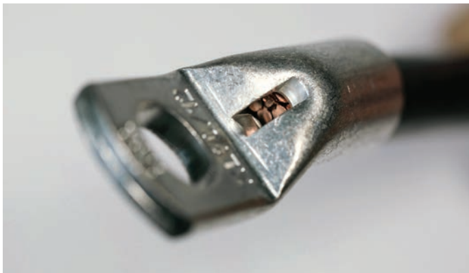
Bild 5: Kabelschuh mit Sichtloch zur Einschub-Kontrolle
