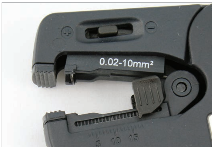
Bild 6: Metrische Bemaßung mit Längenanschlag-Skala
