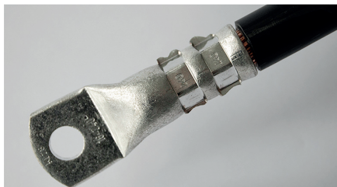
Bild 22: Presskabelschuh nach DIN falsch verpresst (Überpressung)
