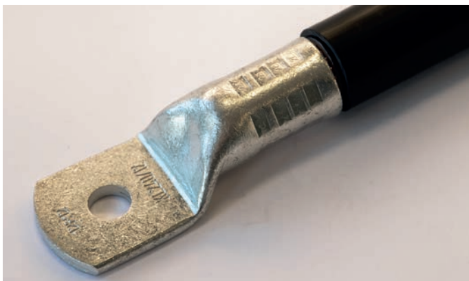
Bild 21: Rohrkabelschuh falsch verpresst (Unterpressung)
