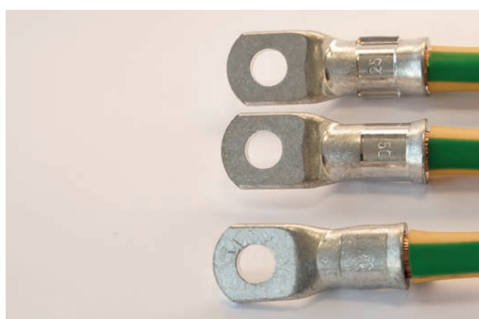
Bild 23: F-Kabelschuh mit Dornverpressung, Rückseite. Überpressung, richtige Verpressung, Unterpressung (v.o.)
