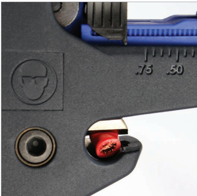
Bild 2: Professionelles Scherschneiden verringert die Handkräfte und sorgt für eine optimale Vorbereitung der weiteren Verarbeitungsschritte
