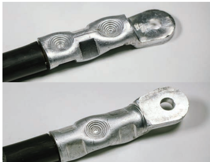
Bild 9: Dornpressung von oben und unten
