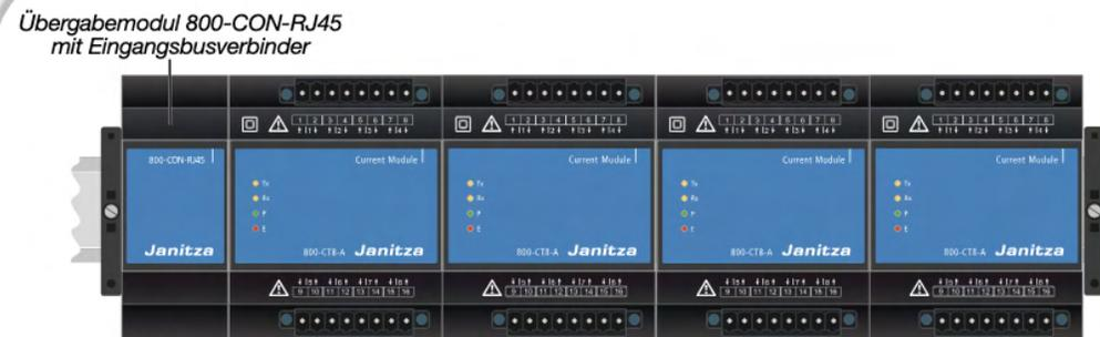
**Beispiel einer JanBus-Topologie mit 10 Modulen, die je einen Modul-Slot am Basisgerät belegen und 4 Übergabemodulen (2 Module 800-DI14, 2 Module 800-CT8-LP, 6 Module 800-CT8-A - Übergabemodule belegen keinen Modul-Slot).**
