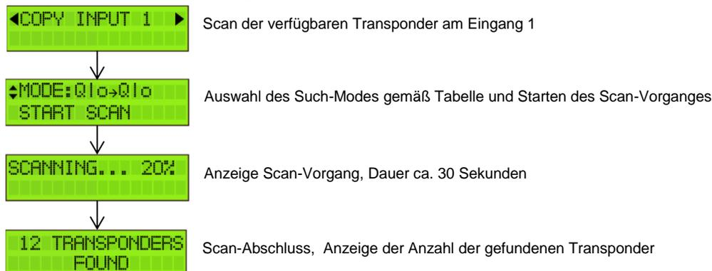
Ist es nötig die gefundenen Transponder zu ändern, so kann dies im Menü „**Input SAT 1- 4**“ unter dem Punkt „**INPUT SAT 1**“ erfolgen. Hier werden die Transponder aus den Scan angezeigt.
