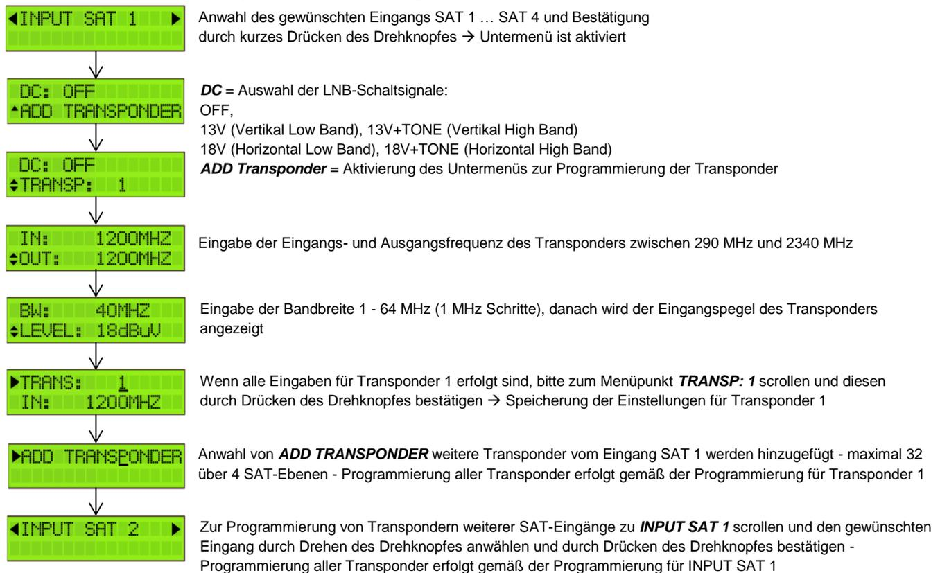
Ist es nötig einen programmierten Transponder zu löschen, so kann dies durch Anwahl des betreffenden Transponders „**TRANS: 17**“ und Drücken des Drehknopfes für 3 Sekunden erfolgen.
