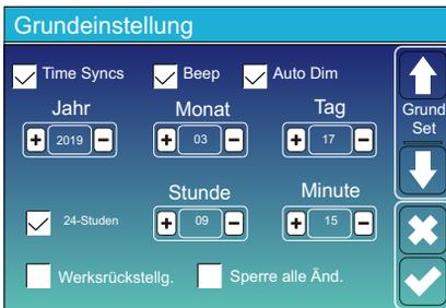
**Werksrückstellung:** Alle Parameter des Wechselrichters zurücksetzen.
