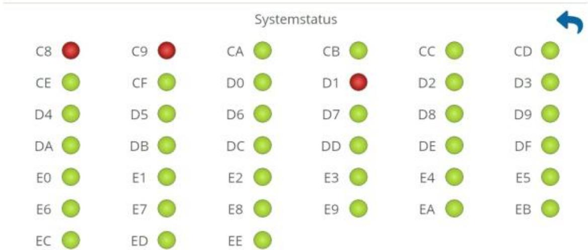
Die Fehleranzeige verschwindet automatisch, sobald das Problem behoben ist. Vergewissern Sie sich nach jedem Einschalten dass das System ordnungsgemäß funktioniert und alle Statusanzeigen grün leuchten.
