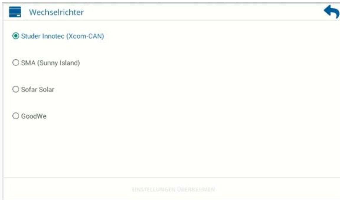
Um die Kompatibilität zu verbessern, einen störungsfreien Betrieb zu gewährleisten und eventuellen Beschädigungen der Batterie vorzubeugen, ist es unerlässlich, seitens des Batteriemangements das Batteriesystem auf die individuellen Eigenheiten der unterschiedlichen Wechselrichter einstellen zu können. Dafür ist es notwendig, den korrekten mit dem Batteriesystem gekoppelten Batterie- oder Hybridwechselrichter auszuwählen.
