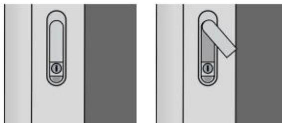
Zum Verschließen der Tür drehen Sie den Hebel wieder nach links und führen anschließend den Hebel durch leichten Druck zurück in die Fassung. Wenn der Schrank abgeschlossen ist, lässt sich der Hebel nicht entriegeln.
