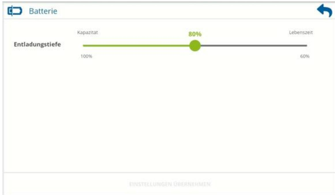
Der Konfigurationsbereich **Batterie** erlaubt es, die **Entladungstiefe** des Batteriesystems individuell einzustellen. Je nach Anwendung und verwendetem Wechselrichter, kann eine vom Standard abweichende Einstellung der **Entladungstiefe** sinnvoll sein.
