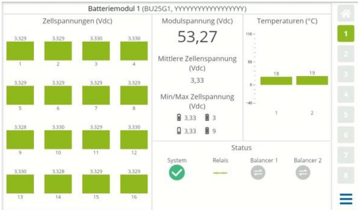
Die Modulanzeigen bieten eine detaillierte Darstellung des momentanen Zustandes und Status eines jeden Batteriemoduls.
