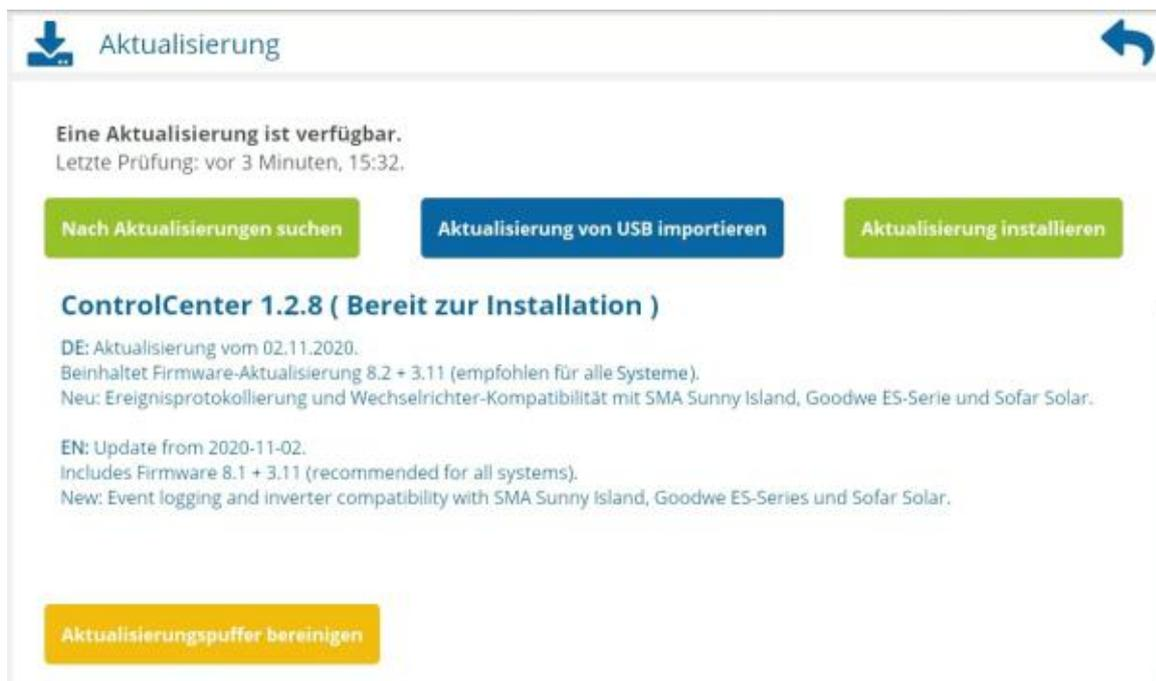
Nachdem eine Aktualisierung bereit zur Installation ist (heruntergeladen oder importiert), tippen Sie auf **Aktualisierung installieren**.
