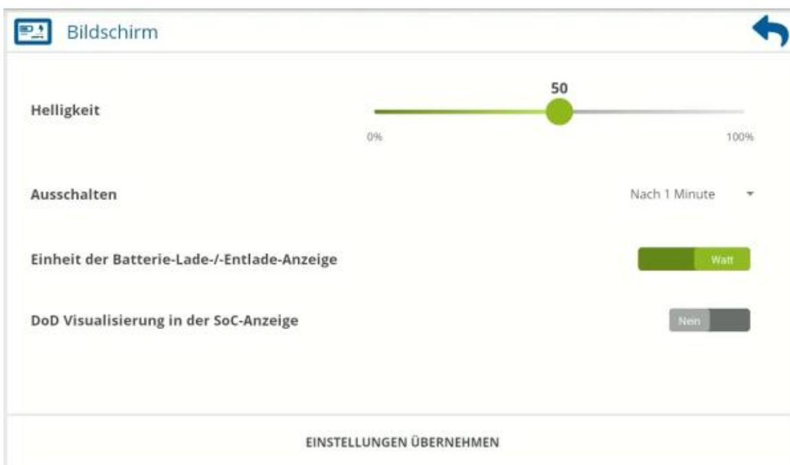
Um die **Helligkeit** oder Abschaltzeit (**Ausschalten**) des Bildschirms sowie die SoC-Anzeige oder die Lade-/Entlade-Anzeige der Systemübersicht anzupassen, wechseln Sie in die **Einstellungen** [⚙️] und gehen dann auf **Bildschirm** [📺].
