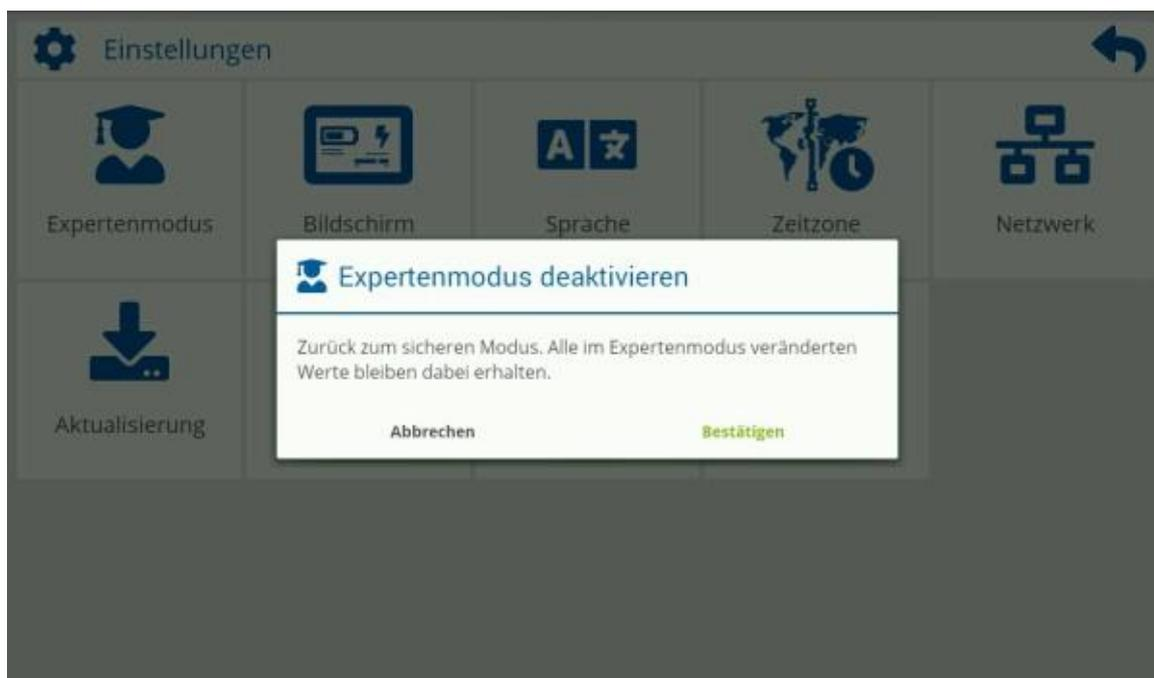
Um den Expertenmodus wieder zu deaktivieren und in den sicheren Standard-Benutzer-Modus zu wechseln, gehen Sie zunächst in die **Einstellungen** [
