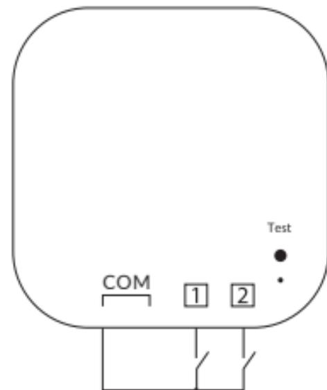
Steuereingang 1 und 2 sollten mit einem Schalter (z. B. Taster, Lichtschalter oder Rollladenschalter) verbunden werden, um andere Produkte von Plejd drahtlos zu steuern.
