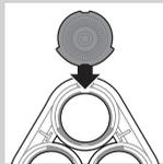
*Hinweis: Achten Sie darauf, dass die Vorsprünge an den Scherköpfen genau in die Aussparungen des Scherkopfhalters passen.*
