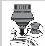
**1** Stecken Sie die Führung des Aufsatzes in den Schlitz oben am Gerät. Drücken Sie den Aufsatz dann nach unten, sodass er hörbar auf dem Gerät einrastet.
