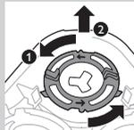
**3** Drehen Sie die Halteringe gegen den Uhrzeigersinn, und entfernen Sie sie.
