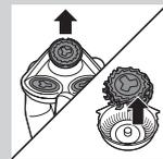
**4** Entfernen Sie die Scherköpfe vom Scherkopfhalter. Jeder Scherkopf besteht aus einem Schermesser und einem Scherkorb.
