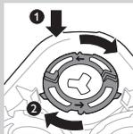
**8** Setzen Sie die Halteringe wieder auf den Scherkopfhalter, und drehen Sie sie im Uhrzeigersinn.
