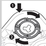
**7** Setzen Sie die Halteringe wieder auf die Scherkopfhalter, und drehen Sie sie im Uhrzeigersinn.
