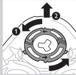
**4** Drehen Sie die Halteringe gegen den Uhrzeigersinn, und entfernen Sie sie.
