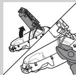
**4** Nehmen Sie das Akkufach heraus, und schneiden Sie die Akkulaschen mit einer Drahtschere ab.
