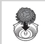
**6** Setzen Sie nach dem Reinigen das Schermesser wieder in den Korb.
