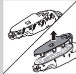
**3** Brechen Sie die Haken durch, und nehmen Sie die Vorderseite der Stromeinheit ab.
