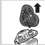
**2** Ziehen Sie den Scherkopfhalter vom unteren Teil der Schereinheit ab.
