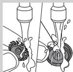
**5** Reinigen Sie das Schermesser und den Scherkorb unter fließendem Wasser.
