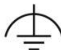
Anschluss des Schutz-Potenzialausgleichleiters
