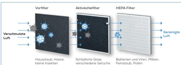
Funktionsweise des Luftreinigers: Hausstaub, Tierhaare, Gerüche, Pollen, schädliche Gase sowie diverse Bakterien und Viren werden mit Hilfe eines dreischichtigen Filtersystems aus der Luft gefiltert.
