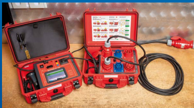
Prüfung einer 5-poligen CEE-Verlängerung
