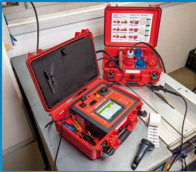
Aktive Prüfung einer 3-phasigen Tischkreissäge
