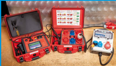
Prüfung einer mobilen Stromverteilung mit RCD
