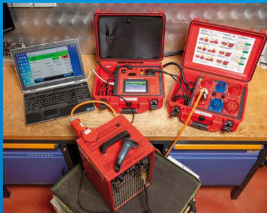
Prüfung eines 3-phasigen Heizlüfters
