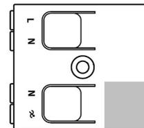
Geschalteter Netzausgang 230V max. 0,6A: Kann genutzt werden, um Standbyströme zu vermeiden oder eine vollständige Abschaltung der angeschlossenen Geräte bei 0% Dimmung über die Casambi App zu ermöglichen.
