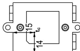
Achten Sie beim Einbau auf die Lage der Antenne und vermeiden Sie größere metallische Umbauungen oder planen Sie ggf. eine Aussparung für die Antenne ein. Es empfiehlt sich bei allen Umbauungen die Reichweite zu testen. Die Lage und Größe der empfohlenen Aussparung können Sie der folgenden Zeichnung entnehmen.
