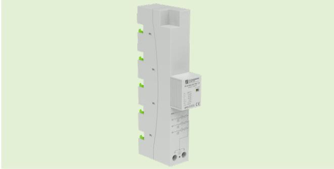
Kombi-Ableiter für Blitzströme Typ 1+2+3 zur Montage auf 40 mm Sammelschienensysteme wird in 3-phasigen Netzsystemen nach Blitzschutzklasse III und IV durch einfaches Aufrasten auf das Schienensystem installiert.
