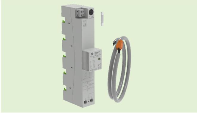
Kombi-Ableiter für Blitzströme Typ 1+2+3 zur Montage auf 40 mm Sammelschienensysteme wird in 3-phasigen Netzsystemen nach Blitzschutzklasse III und IV durch einfaches Aufrasten auf das Schienensystem installiert.
