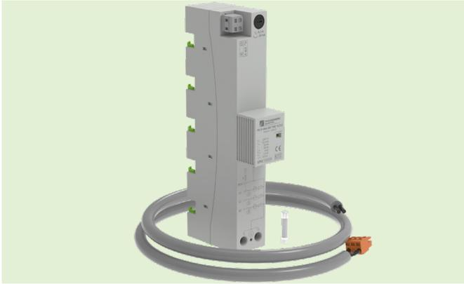
Kombi-Ableiter für Blitzströme Typ 1+2+3 zur Montage auf 40 mm Sammelschienensysteme wird in 3-phasigen Netzsystemen nach Blitzschutzklasse III und IV durch einfaches Aufrasten auf das Schienensystem installiert.
