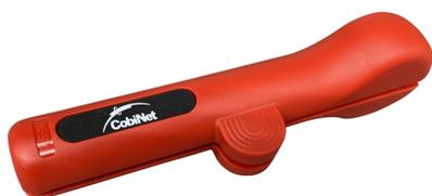
Für die Installation von RJ45-TL®-Buchsen empfiehlt CobiNet das Standard-Abmantelwerkzeug CobiNet CS1 (Art.-Nr.: 8010 156) mit einstellbarem Längenanschlag zum definierten Absetzen des Kabelmantels und Anritzen der Paarfolien für Netzkabel mit 3 – 10 mm Durchmesser.
