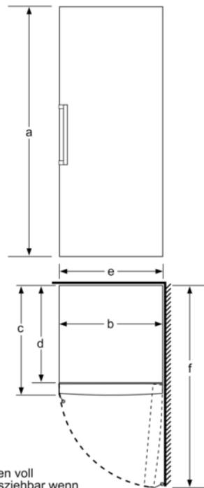
Schalen voll herausziehbar wenn das Gerät direkt an einer Wand platziert wird.
