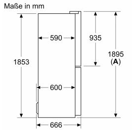
A: Front ist von 1895–1910 mm, bei voll ausgezogenen vorderen Nivellierfüßen, verstellbar
