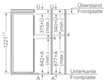
Die angegebenen Möbelmaßmaße gelten für eine Türfuge von 4 mm. Bei Verwendung einer anderen Fugenbreite (max. 14 mm) müssen die Maße angepaßt werden.
