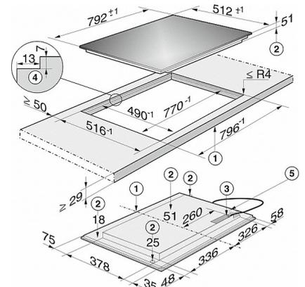
KM 6367 PowerFlex (Skizze) - Einbau in Massivholz- und geflieste Arbeitsplatten
