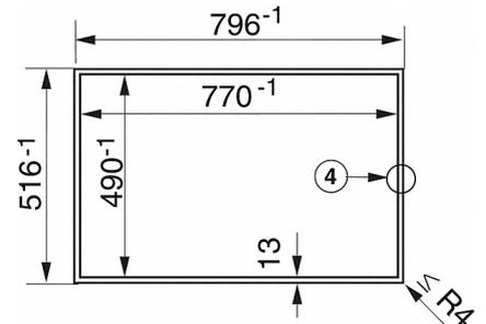
KM 6367 PowerFlex (Skizze) - Einbau in Naturstein-Arbeitsplatten
