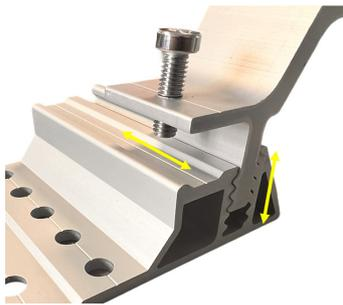
Ermöglicht eine vertikale und horizontale Feinjustierung im vorgegebenen Toleranzbereich, was eine **flexible** und anpassungsfähige Installation unterstützt.
