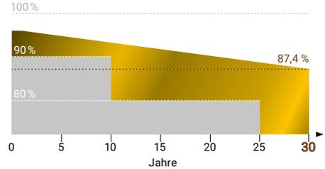
■ Lineare Leistungsgarantie für Glas-Glas Solarmodule
