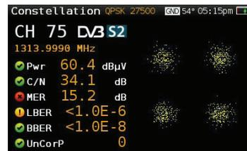
Konstellationsdiagramm bei einer DVB-S2 Messung
