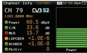
Kanalinformation mit Ampeldarstellung einer DVB-S2 Messung
