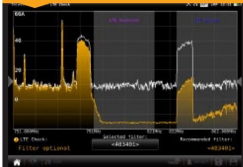
Zur Analyse von Auswirkungen des LTE-Signals auf die DVB-T/T2-Kanäle und Erkennung ob der Einsatz von Filtern erforderlich ist. Darüber hinaus ermöglicht die Funktion die Spektrumsimulation bei der Implementierung eines vom Messgerät empfohlenen LTE-Filters. Es wird eine Liste von Filtern angezeigt, aus der der Benutzer diejenigen auswählen kann, die seinen Anforderungen am besten entspricht.
