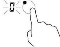
2. Schalten Sie die Kochzone aus, indem Sie "-" nach unten bis "0" blättern. Vergewissern Sie sich, dass auf dem Display "0" angezeigt wird. Oder berühren Sie die Tasten "+" und "-" gleichzeitig, um die Kochzone direkt einzustellen. auf "0".
