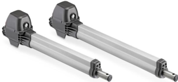
Die Drehtorantriebe twist M und twist ML sind für Tore bis 2,5 m Torflügelbreite oder 300 kg Torflügelgewicht. Der längere Bewegungshub des twist ML ermöglicht Öffnungswinkel bis 130°. Außerdem kann der twist ML steiler zum Tor verbaut und auch an sehr breiten und gemauerten Pfosten montiert werden.
