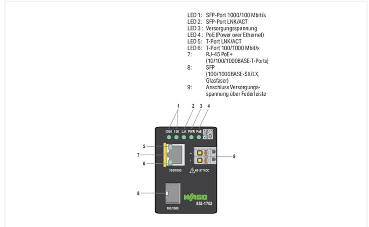
Das Gerät ist ein industrieller Medienconverter mit einem Gigabit-ETHERNET-Port und einem SFP-Port (100BASE/1000BASE) für das Anbinden von dezentralen ETHERNET-Geräten über Lichtwellenleiter an ein Netzwerk. Der Anwender kann das hierfür notwendige SFP-Modul frei wählen und über eine Entfernung von bis zu 80 km kommuniziert. Der ETHERNET-Port (IEEE 802.3at) kann zeitgleich zur Energieversorgung von PoE-Endgeräten (Powered Devices) eingesetzt werden. (SFP-Module sind optional erhältlich)
