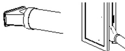
3. Öffnen Sie das Fenster und sperren Sie einen der beiden Fensterflügel mit dem Griff. Setzen Sie den Endanschluss am feststehenden Flügel auf und lehnen Sie den anderen Flügel an.
