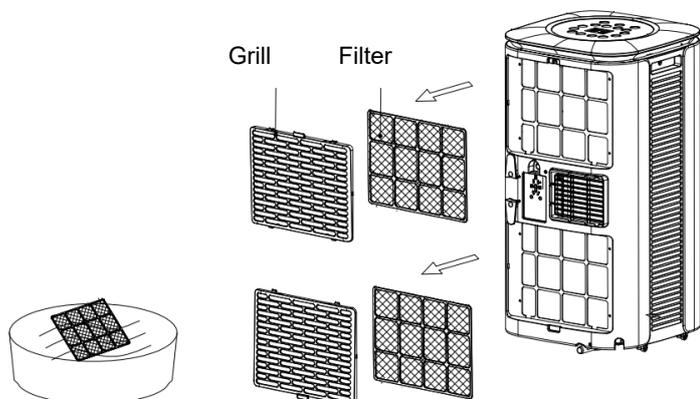
Verwenden Sie einen Staubsauger, um den Staub abzusaugen. Falls dies nicht ausreichen sollte, den Filter mit lauwarmem Wasser und ggf. neutralem Reinigungsmittel waschen; mit kaltem Wasser spülen und auf natürliche Weise trocknen lassen, bevor er erneut eingesetzt wird. Nach dem erneuten Einsetzen des Filters das Gitter verschließen; Sie können Ihr Klimagerät jetzt wieder in Betrieb nehmen.
