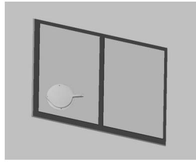
3. Setzen Sie den runden Anschluss für das Fensteradapter-Set in den einziehbaren Schlauch ein und fügen Sie den einziehbaren Schlauch mit dem runden Anschluss in den Fensteradapter ohne den Verschlussdeckel ein.
