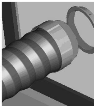
5. Den so montierten Schlauch auf der Rückseite des Klimageräts einfügen.
