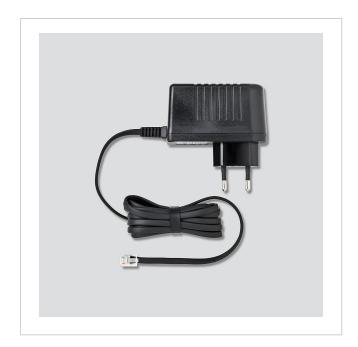
Steckernetzteil 100-240 V AC, Sek. 6 V DC, 1,2 A S/SZM 85x-..., SGM 650-...
