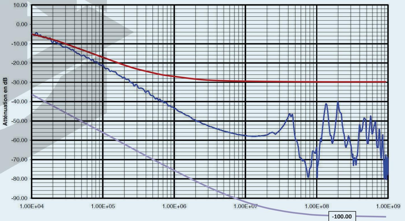
Les mesures ci-dessus réalisées par le LCIE montrent que les Presse Etoupe SIB-TEC CEM à cage vous permettent de réduire de façon sensible les perturbations électromagnétiques créées autour de vos câbles
