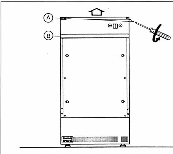
1. Die beiden Schrauben (A) herausdrehen und Bedienblende abnehmen. Blende (B) abschrauben.
