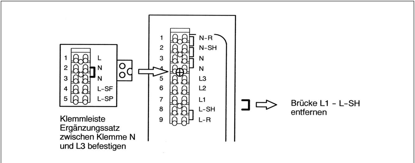
Anschlüsse L, N, L-SF, L-SP an der Klemmleiste des Ergänzungssatzes herstellen. Schutzleiter PE anschließen.
