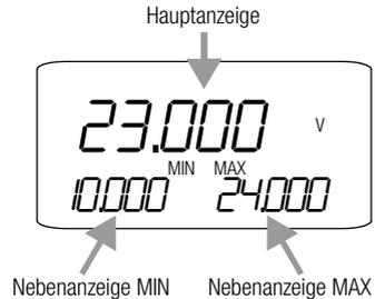
Während die Hauptanzeige unmittelbar nach dem Einschalten des Multimeters erscheint, müssen die beiden Nebenanzeigen durch Betätigen der Taste DATA/CLEAR aktiviert werden. (ausgenommen Stellung M $\Omega$ @...V, wo die Nebenanzeigen unmittelbar nach der Anwahl der Funktion erscheinen)
