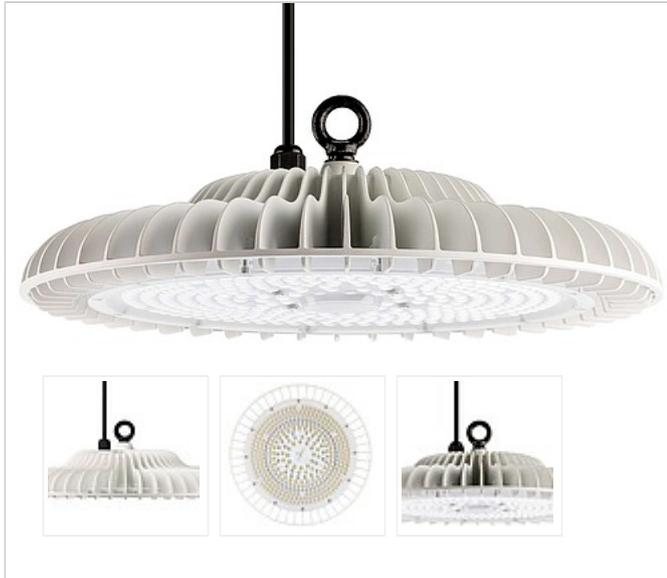
LED Strahler in kompakter runder Bauweise mit integriertem Vorschaltgerät. Abdeckklinsen mit optimaler innen Struktur zur Blendungs- begrenzung aus PC, Gehäuse aus einer Aluminium Legierung, weiß pulverbeschichtet, kurze alterungsbeständige Silikon Dichtungen, Standardbefestigung durch Aufhänge Öse, Decke- oder waagerechte Wandmontage mit weiterem Zubehör möglich, ohne Durchgangsverdrahtung.
