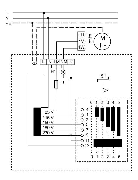
H1 - Betrieb (grün) S1 - Schalter: Ein/Aus M1 - Ventilatormotor
