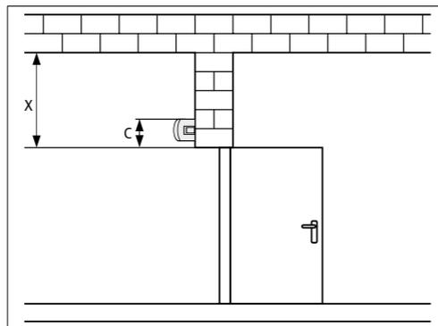
Drehflügeltür bis 3 m lichte Breite, Deckenhöhe über Unterkante Sturz X bis 1 m (C= max. 0,1 m, X= max. 1 m)
