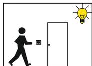
Der Indoor 140-L schaltet im VA-Betrieb das Hauptlicht.
