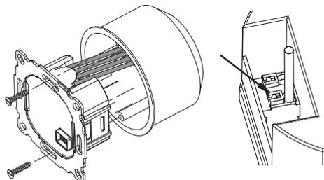
Die Drähte müssen so montiert werden, dass der Kunststoffstreifen als Isolation zur Befestigungsschraube wirkt.
