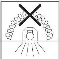
Die Leuchte kann durch nicht ausreichende Wärmeableitung beschädigt werden.
