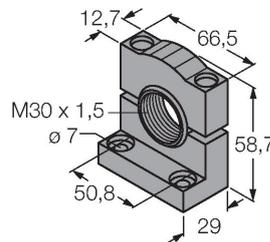
Montagehalterung, PBT-schwarz, für Sensoren mit 30-mm-Gewinde, ausrichtbar
