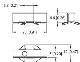
Klemmstück zur Montage von Magnetfeldsensoren auf Rundzylindern
