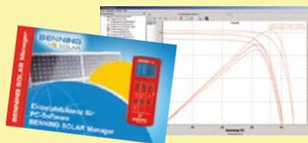
Mit der PC-Software BENNING SOLAR Manager werden die Ergebnisse, die aufgezeichnete I-U-Kennlinie und die Leistungskennlinie des BENNING PV 2 sicht- und bewertbar. Es wird die gemessene und auf STC-umgerechnete Kennlinie angezeigt. Die nominale Kennlinie wird aus der Moduldatenbank gewählt und als Vergleich hinzugezogen. Dokumente, Zeichnungen und Berichte der Photovoltaik-Anlage und deren Komponenten lassen sich archivieren und dokumentieren.
