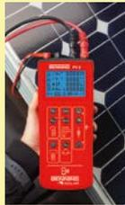
Die Messung von Verbindungen (Niederohmmessung), der Leerlaufspannung bis 1 kV, des Kurzschlussstromes bis 15 A DC und des Isolationswiderstandes sind die Standards für PV-Systeme. Das BENNING PV 2 bietet die eigenständige, permanente Riso-Messung für die Fehlersuche mit den Prüfspannungen 250 V, 500 V und 1000 V DC.
