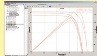
Die Kennlinienmessung zeigt im Display des BENNING PV 2 den Strom und die Spannung im MPP sowie den Füllfaktor, die Leerlaufspannung und den Kurzschlussstrom an. Die Kennlinien werden mit dem BENNING SOLAR Manager oder mit der App BENNING PV Link dargestellt.
