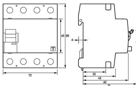
Maßzeichnung Fehlerstromschutzschalter DFS 4 063-4/0,10-PV R HD
