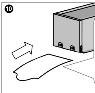
11 ! STRL-LK060-Z 690... Lichtlenkungsfolien von Rolle einziehen. Montageanweisung 830871 für Lichtlenkungsfolien (nanoOptix) beachten!
