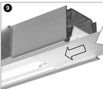
⚠ STRL-LK060-Z 690... Lichtenkungsfolien von Rolle einziehen. Montageanweisung 830871 für Lichtenkungsfolien (nanoOptix) beachten!
