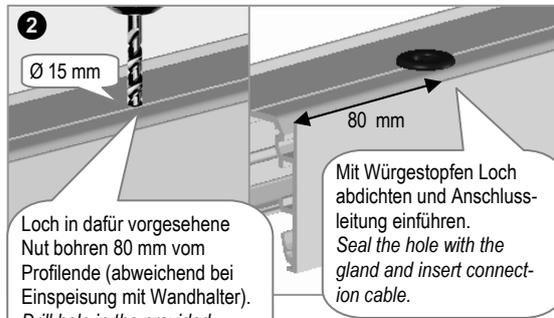
Loch in dafür vorgesehene Nut bohren 80 mm vom Profilenende (abweichend bei Einspeisung mit Wandhalter).
