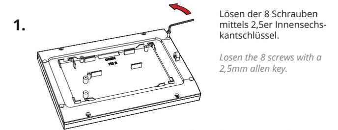
Lösen der 8 Schrauben mittels 2,5er Innensechskantschlüssel.
