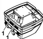
Vattennivåsensorena (1) ska rengöras regelbundet och undersökas efter tecken på skador.
