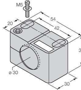
Befestigungsschelle für Gewinderohrsensoren, mit Festanschlag; Werkstoff: PA6
