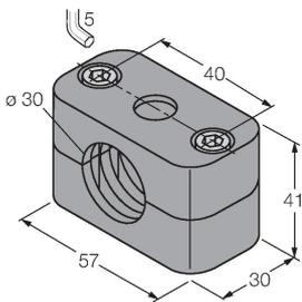
Befestigungsschelle für Glatt- und Gewinderohrsensoren; Werkstoff: Polypropylen
