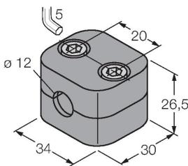
Befestigungsschelle für Glatt- und Gewinderohrsensoren; Werkstoff: Polypropylen
