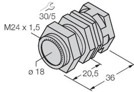
Schnellmontagehalterung mit Festanschlag; Werkstoff: Messing verchromt. Außengewinde M24 x 1,5. Hinweis: Der Schaltabstand der Näherungsschalter kann sich durch Verwendung von Schnellmontagehalterungen ändern.
