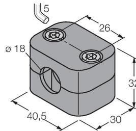
Befestigungsschelle für Glatt- und Gewinderohrsensoren; Werkstoff: Polypropylen
